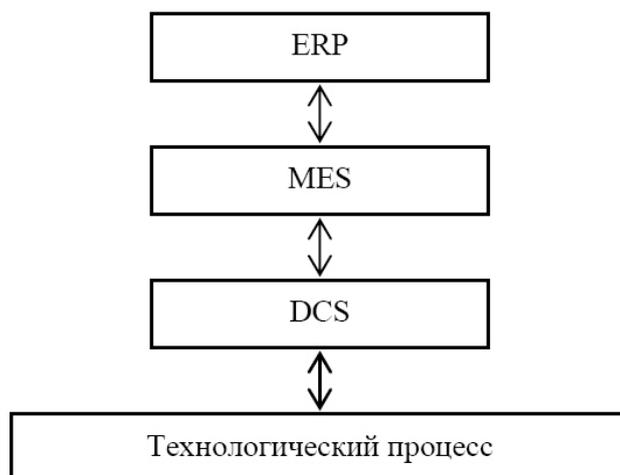
Рис. 1.1. Блок-схема автоматизированной системы управления
